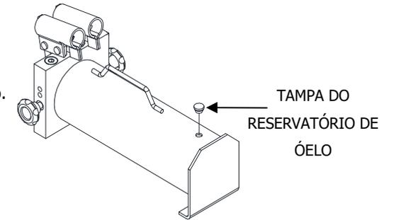
3. Deixe escorrer o óleo e inclua o novo na quantidade especificada na lista de peças da caixa hidráulica
